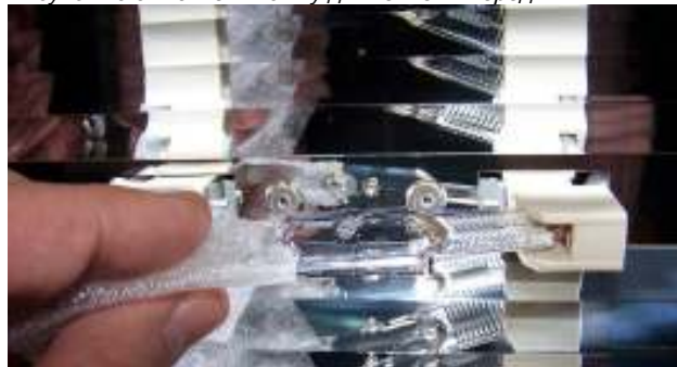
Рисунок 45.5: Извлечь лампу движением вперёд
