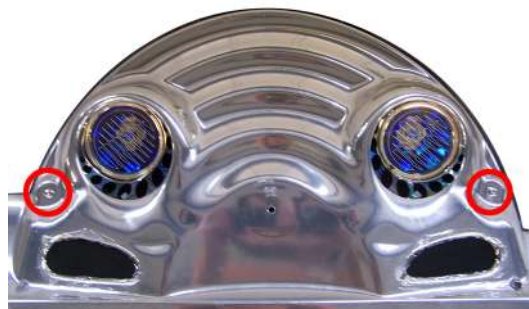
Рисунок 44.3: Отсоединить отражатели на соответствующем пусковом устройстве от электрооборудования
