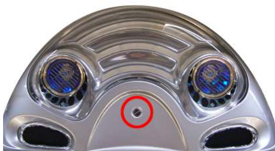
Рисунок 44.1: Отвернуть винт наружной обшивки
