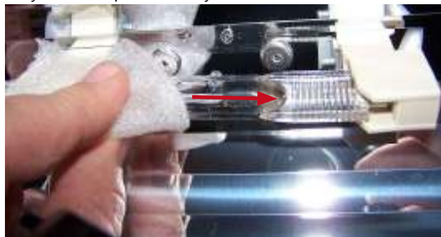
Рисунок 45.5: Извлечь лампу движением вперёд
