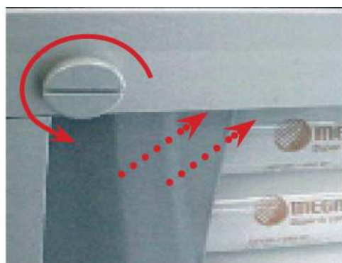
Рисунок 40.2 Черыте винта стекла боковины
