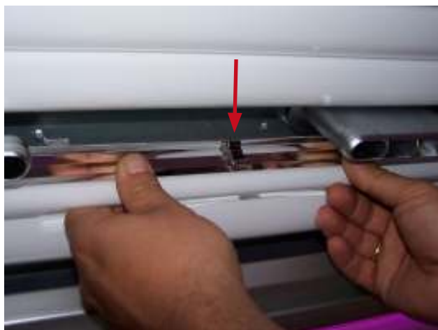
Рисунок 43.2: Средняя удерживающая скоба лампы P2
