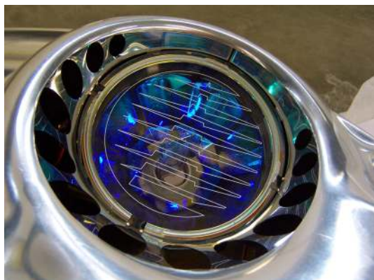
Рисунок 45.3: Отражатель, правильно установленный под хромированной крышкой
