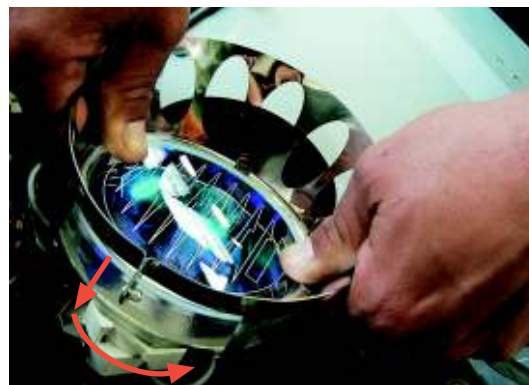
Рисунок 44.5: Развести скобу и извлечь излучатель с патроном
